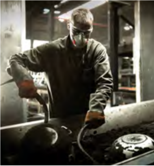
Lösen der Gussteile aus der Form und Entfernen von überschüssigem Metall
