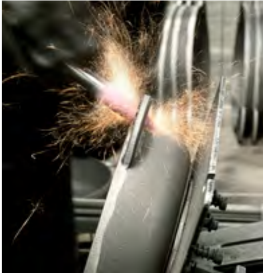
Entfernen von Unebenheiten (Entgraten)
