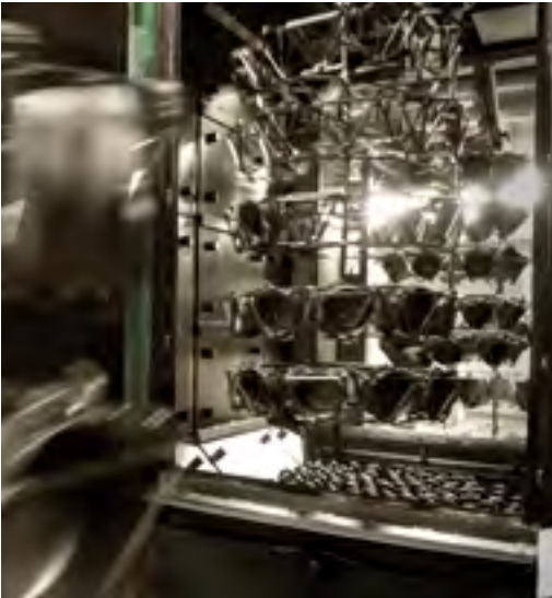
Kugelstrahlen als Vorbereitung für die Emaillierung
