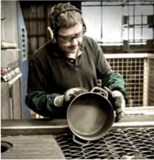
Reinigungsstrahlen zur Entfernung von Formsand
