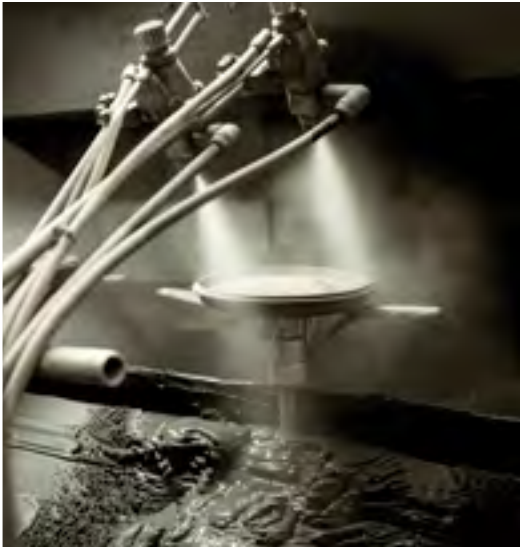
Emaillierung mit 2 bis 3 Schichten, innen und außen
